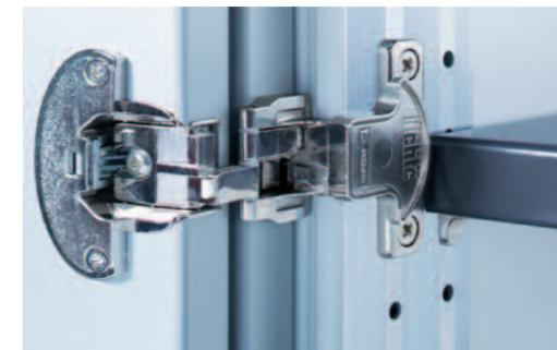
*Das Aluminiumprofil ermöglicht durch die doppelte Lochreihe eine uneingeschränkte Nutzung über die gesamte Schrankhöhe. Während in der vorderen Reihe ausschließlich die Türbänder montiert werden, können auch im Bandbereich Fachböden und Organisations-elemente eingebaut werden.*
